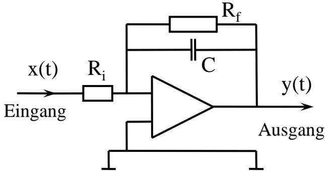
Analoge Filterschaltung (Tiefpass)
